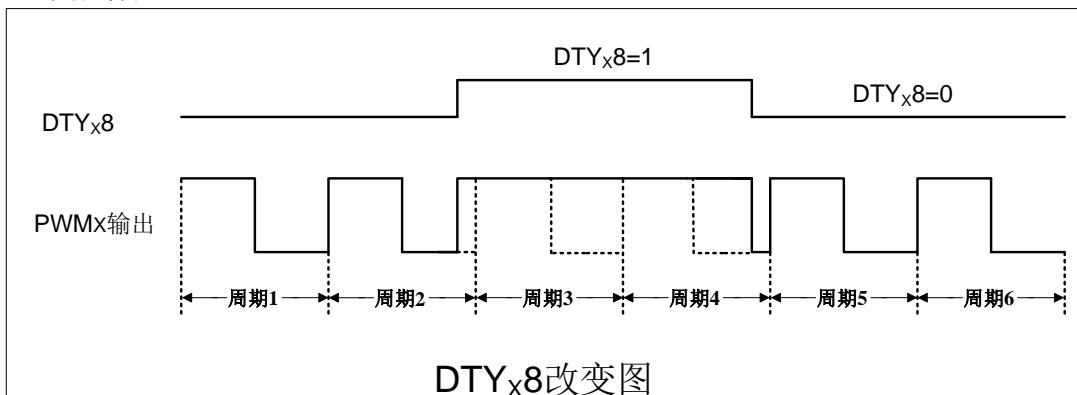
当 PWM<sub>x</sub>输出波形时, 若 DTY<sub>x8</sub>(PWMCR.1/ PWMCR.3)改变, PWM<sub>x</sub>波形会立即改变。如上图所示, 在周期 2 中使 DTY<sub>x8</sub> 置 1, PWM<sub>x</sub> 会立即响应, 固定输出高; 在周期 4 某处 DTY<sub>x8</sub> 清 0, PWM<sub>x</sub> 立即响应, 取消固定输出。
