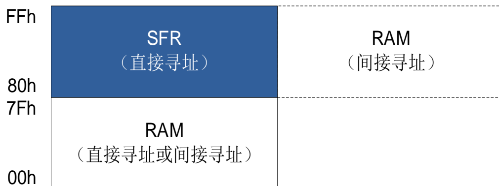
内部 256 bytes RAM 结构图
