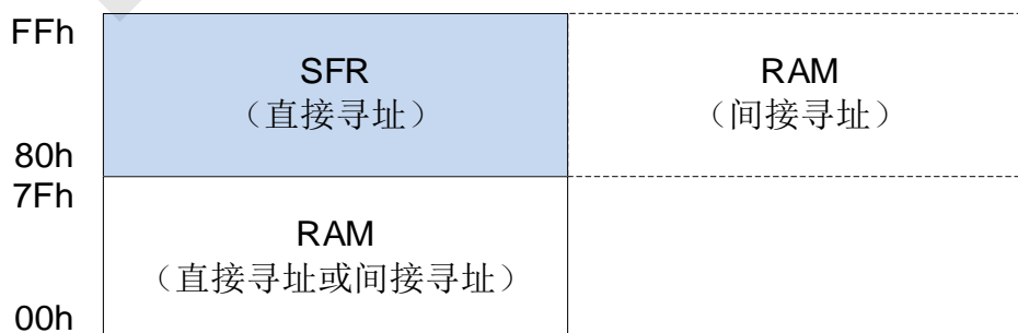
内部 256 bytes RAM 结构图
