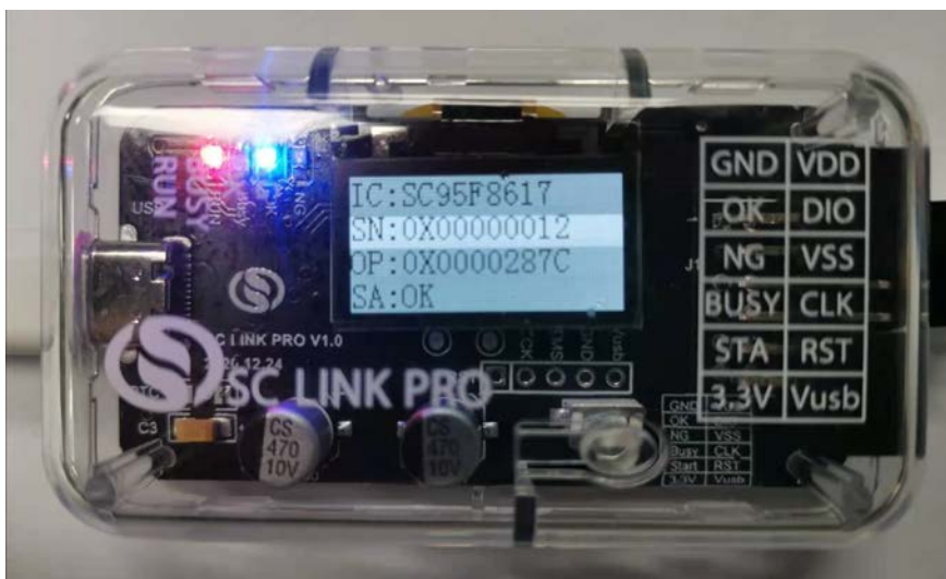
多 Code 模式下脱机烧录成功
