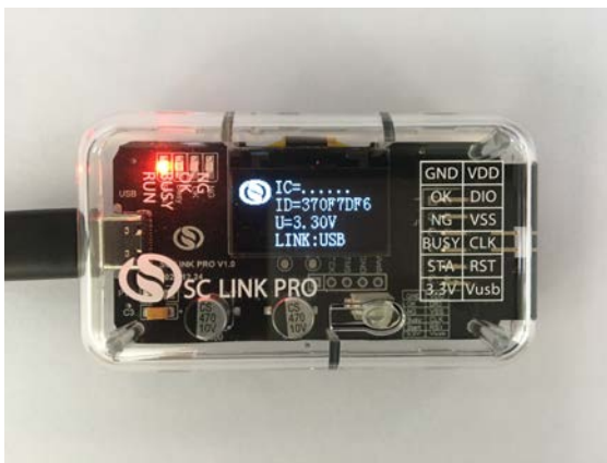
图 2.2.1 SC LINK PRO 显示硬件外观图
