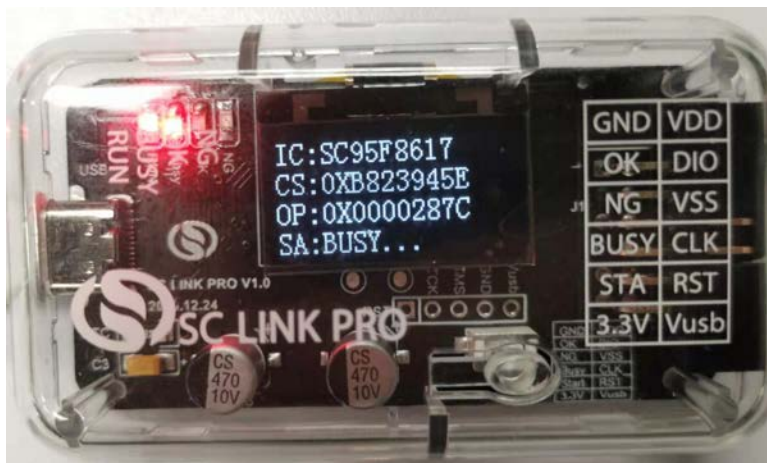
图 2.2.3-1 SC LINK PRO 序列号脱机正在烧录显示效果
