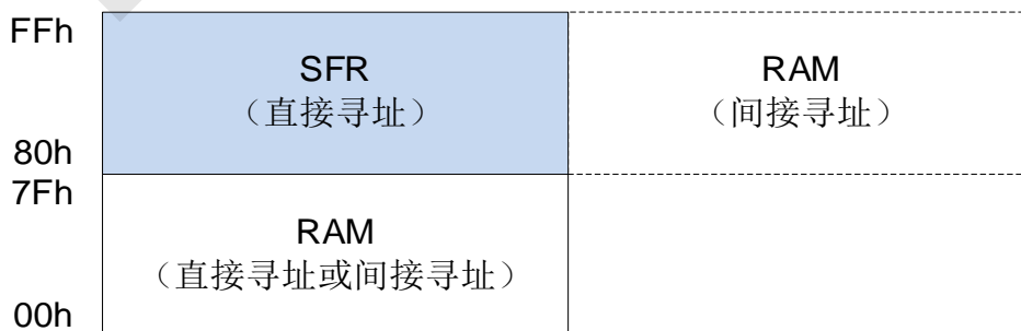
内部 256 bytes RAM 结构图
