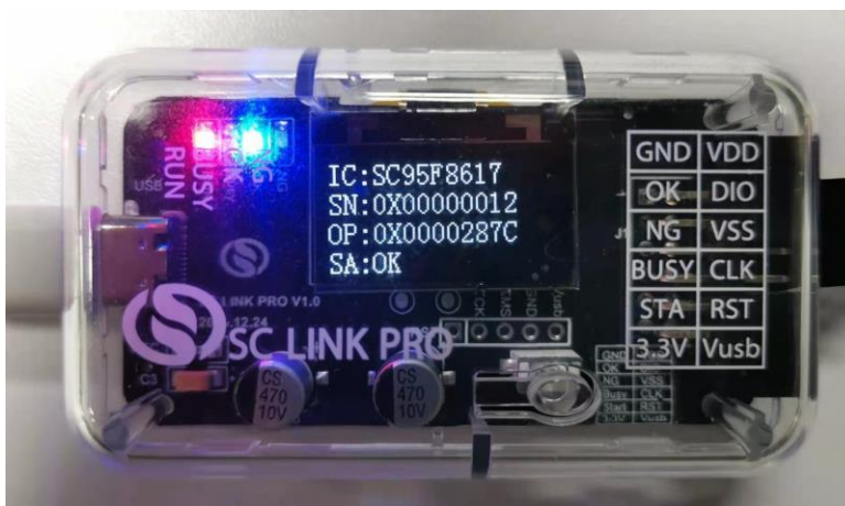
图 2.2.3-2 SC LINK PRO 序列号脱机烧录完成显示效果
