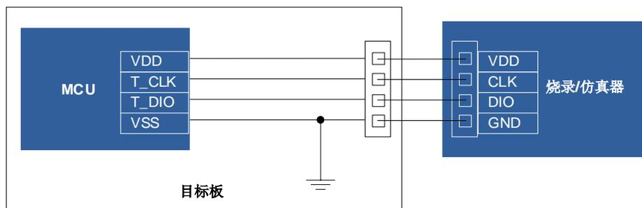
ICP 模式 Flash Writer 编程连接示意图
