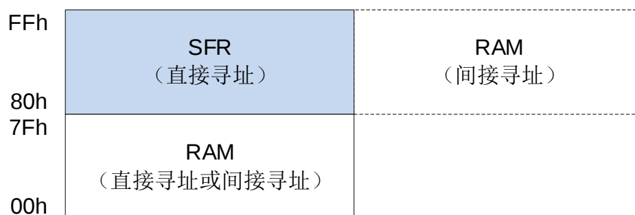
内部 256 bytes RAM 结构图
