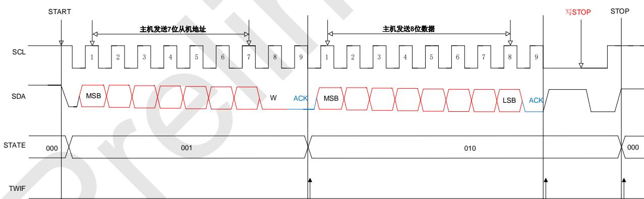
2. 如果从机应答的是高电平（在接收过程中，从机寄存器中的 AA 值改写为 0），表示当前字节传输完以后，从机会主动结束本次传输，回到空闲状态 ( $\text{STATE}[2:0] = 000$ )，不再接收主机发送的数据。
