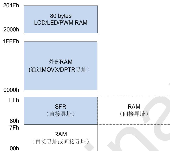
SC95F861XB 单片机的 SRAM，分为内部 256 bytes RAM、外部 8192 bytes RAM 和 80 bytes 的 PWM&LCD RAM。内部 RAM 的地址范围为 00H~FFH，其中高 128 bytes（地址 80H~FFH）只能间接寻址，低 128 bytes（地址 00H~7FH）可直接寻址也可间接寻址。
