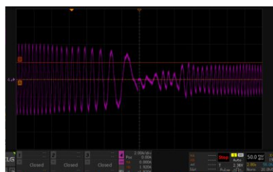
有感FOC正反转切换波形 升降电机，线性Hall，DC29V, 72W
